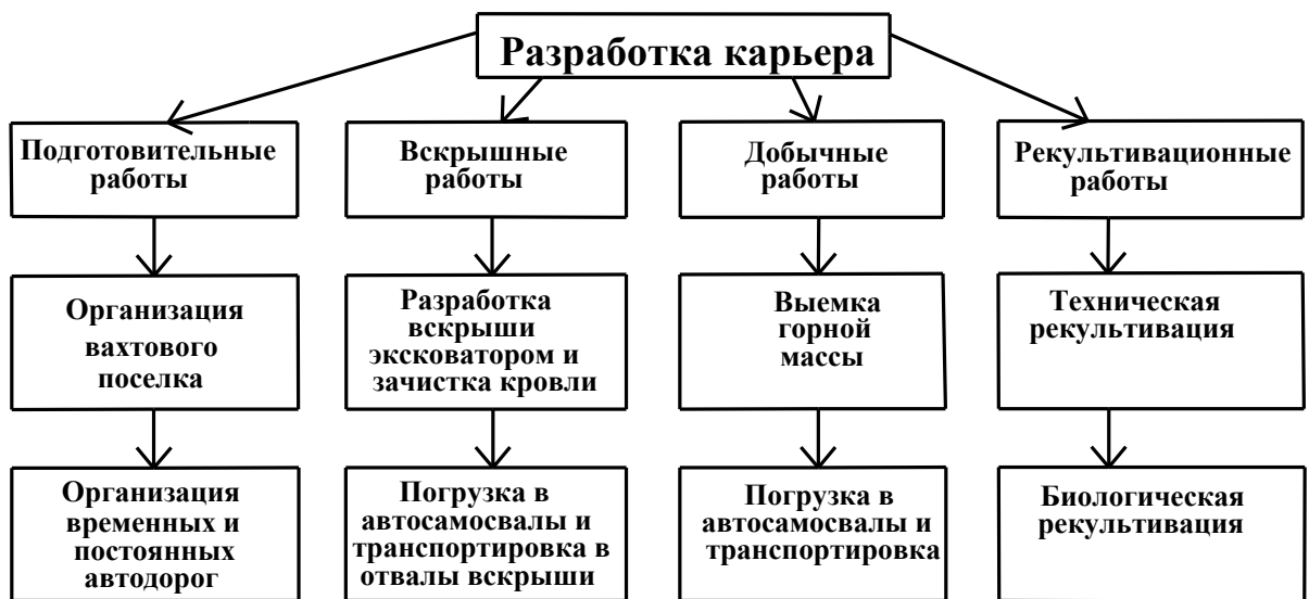
Рис. 9 Схема оптимальных технологических операций при разработке карьера в Белгородской области
