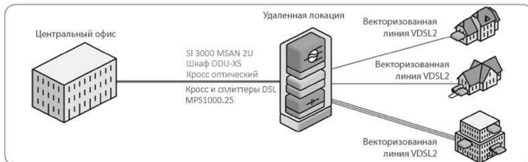
Рисунок 3.2 – Типовое применение технологий FTTC и VDSL2
