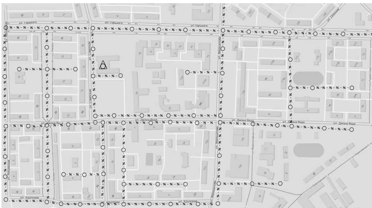
Рисунок 1.2 – Схема телефонно-кабельной канализации микрорайона Спортивный город Серпухов
