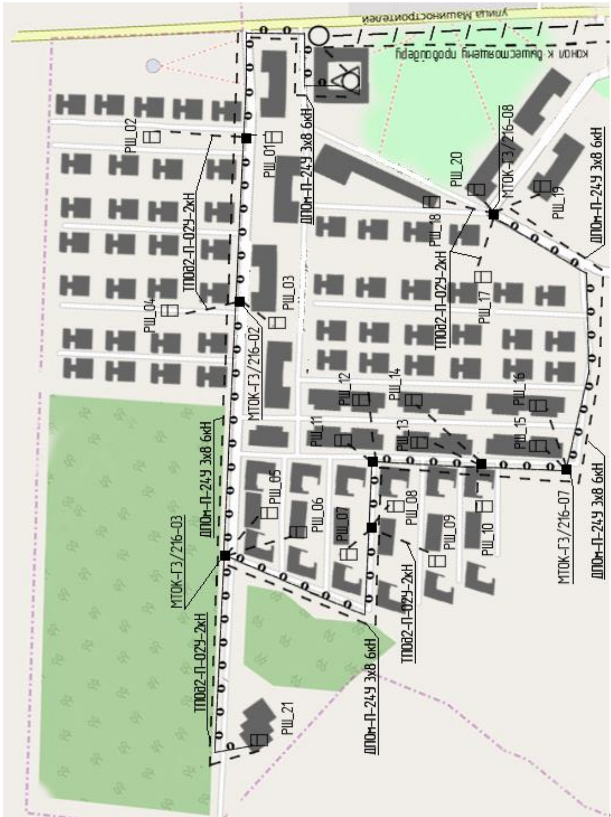
Рисунок 3.6. – Схема проектируемых линейно-кабельных сооружений
