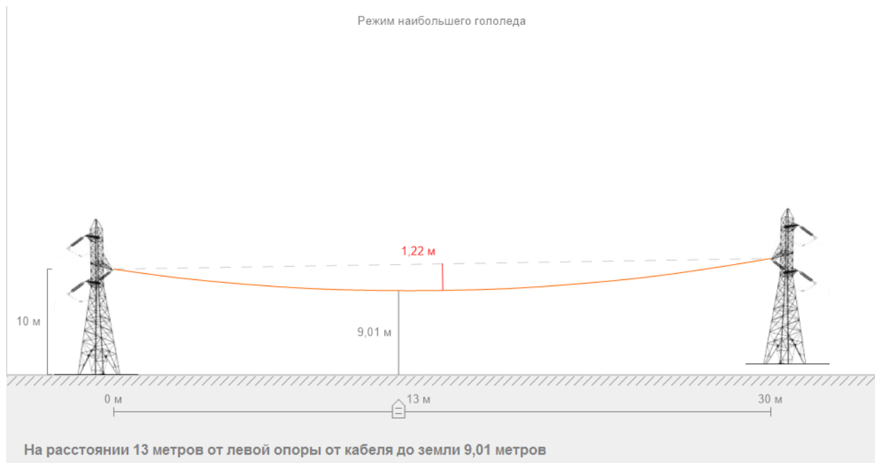
Рисунок 3.4 – Расчет максимального допустимого провеса при монтаже на опорах связи
