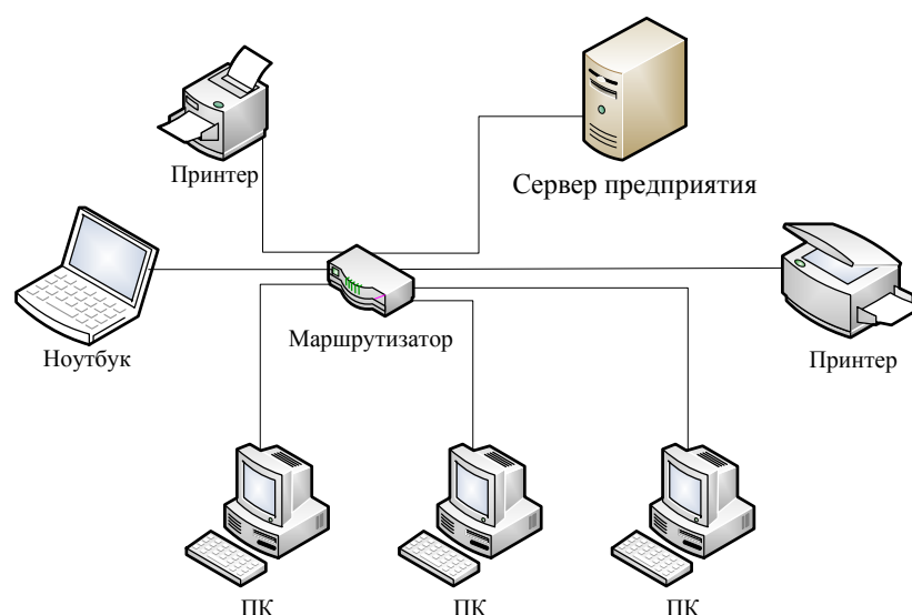
Рисунок 3.11 – Схема организации локальной сети агрономического отдела «как будет»
