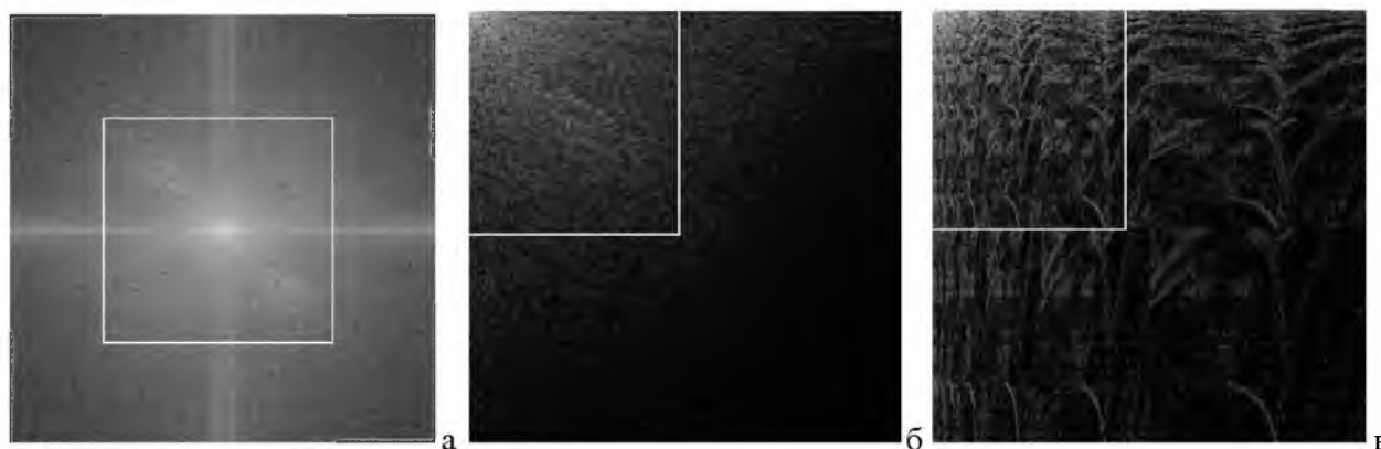
Рис. 1. Примеры областей V_0^d вычисления сосредоточенности C_0^d при d = 0,5 : а – дискретное преобразование Фурье (логарифмированный спектр), б – дискретное косинусное преобразование (логарифмированный спектр), в – преобразование Хаара (логарифмированный спектр)
