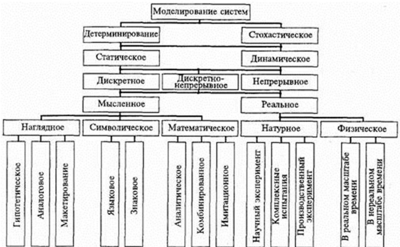
Рисунок 3.1 – Классификация видов моделирования систем
