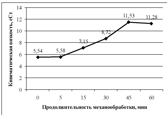
Рис. 1. Зависимость кинематической вязкости водных растворов 1% Na-КМЦ от продолжительности механообработки
