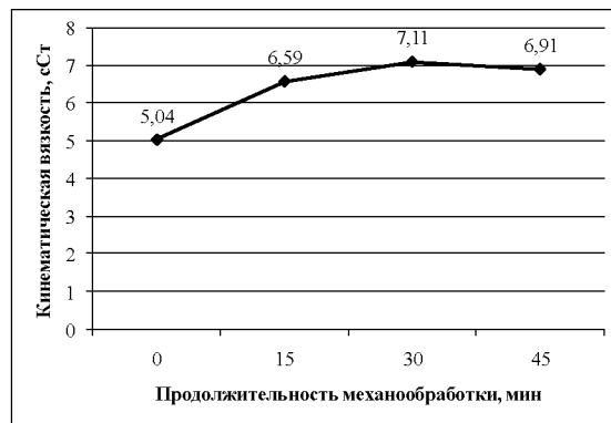
Рис. 2. Зависимость кинематической вязкости водных растворов 3% ПВС от продолжительности механообработки
