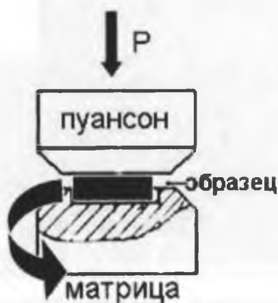
Рис. 1. Принципиальная схема интенсивной пластической деформации ИПДК.
