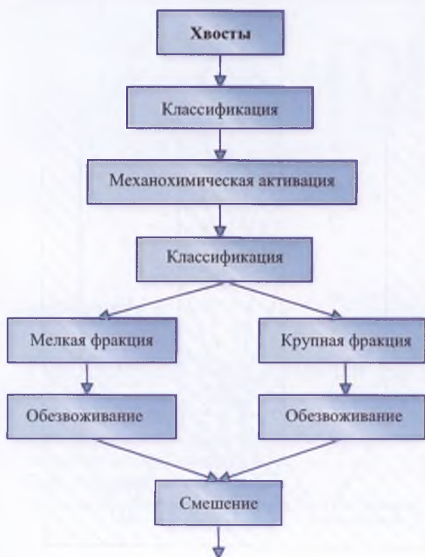
Рис. 2. Схема приготовления твердеющей смеси на основе хвостов обогащения
